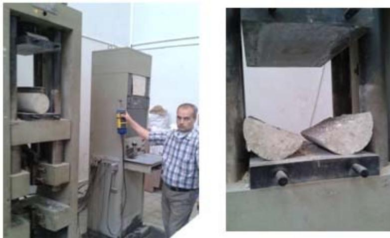
الشكل (144-) جهاز المستخدم لتحديد مقاومة الاسطوانات على الفلق
