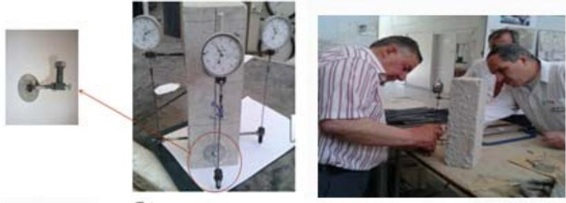
الشكل (154-) لصق الحوامل على أسطح المواشير من أجل اختبار معامل المرونة
