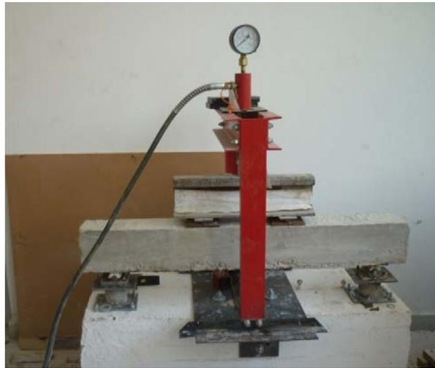
الشكل (224-) جهاز اختبار الانعطاف في هذه الدراسة.
