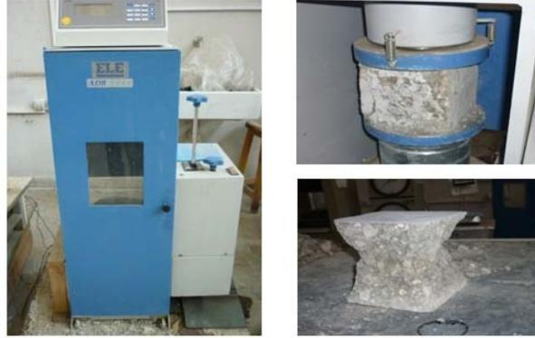
الشكل (134-) جهاز تحديد مقاومة الضغط للعينات المكعبة في هذه الدراسة
