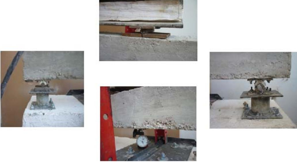
الشكل (234-) كيفية ارتكاز الحمل مع ساعة قياس التشوهات والمساند المصممة.
